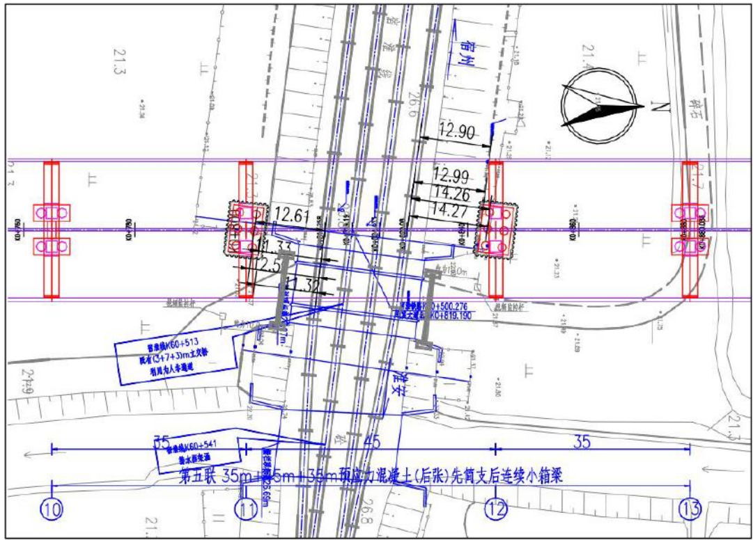
图 3.1-13 跨宿淮铁路横断面布置图
