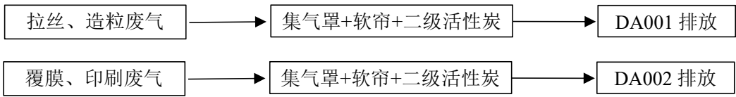
图 6.2-1 项目废气处理工艺示意图
