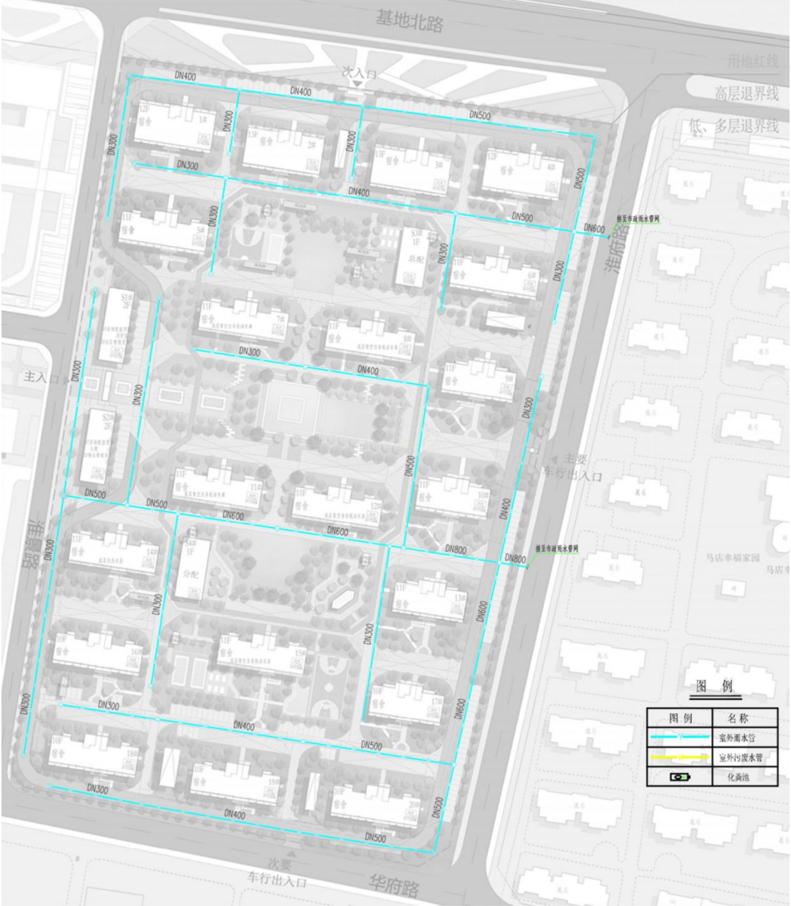
图 2.1-11 项目雨水管网图
