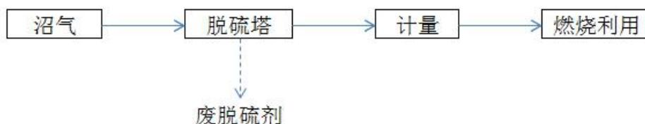
图 3.2-4 沼气净化流程图
